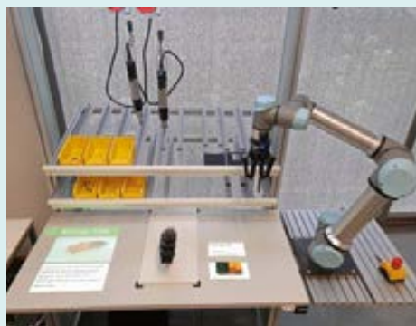
Ein hybrider Arbeitsplatz, bestehend aus einem Werkerassistenzsystem, das beispielsweise Arbeitsanweisungen auf die Arbeitsfläche projiziert, und einem Kollaborativroboter.
