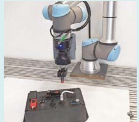
Links: Kollaborative Montagetätigkeiten während der Machbarkeitsstudie. Rechts: Voll automatisiertes Recycling von Elektroschrott: Der Roboter lokalisiert den schwarzen Kasten mithilfe einer Kamera und entfernt anschließend Netzwerkstecker sowie Batterien aus einem Batteriefach.
