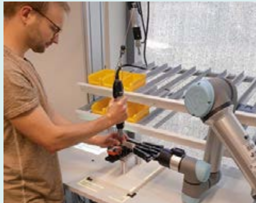
Links: Kollaborative Montagetätigkeiten während der Machbarkeitsstudie. Rechts: Voll automatisiertes Recycling von Elektroschrott: Der Roboter lokalisiert den schwarzen Kasten mithilfe einer Kamera und entfernt anschließend Netzwerkstecker sowie Batterien aus einem Batteriefach.
