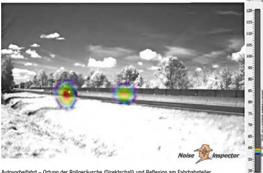
Autovorbeifahrt – Ortung der Rollgeräusche (Direktschall) und Reflexion am Fahrbahnteiler.
