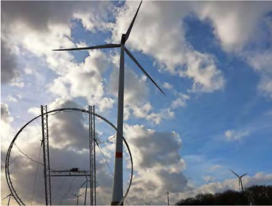
Ein Windarray im Einsatz an einer Windenergieanlage.
