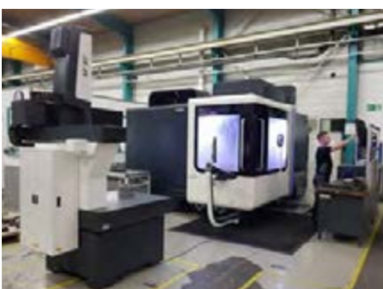
Das neue Koordinatenmessgerät SF 87 ist das universelle Messgerät für die Fertigungsumgebung. Es ist für einen großen Teil der spannenden und umformenden Industrie geeignet. Fotos: Wenzel
