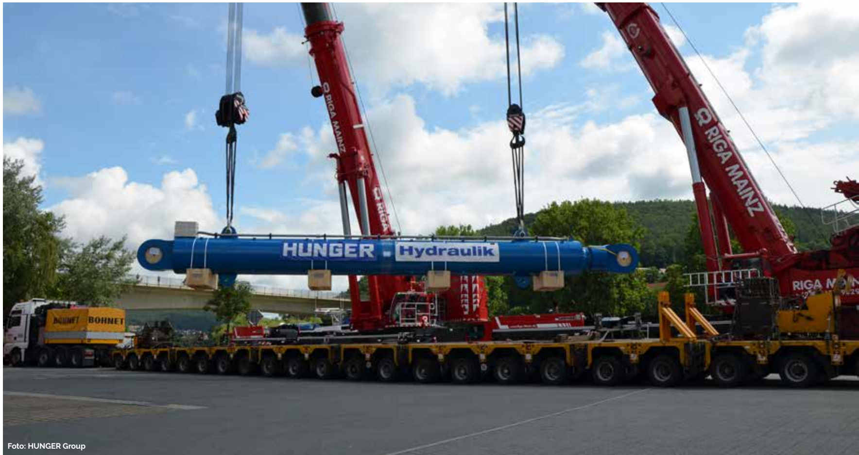
Ein 200 Tonnen schwerer Hydraulikzylinder von Hunger auf dem Weg nach Shanghai
